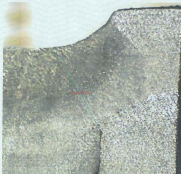
شکل 22. تصویر ماکروسکوپی از مقطع عرضی آماده سازی شده. (مقطع 22) محلول ظاهر کننده: نایتال ده درصد
