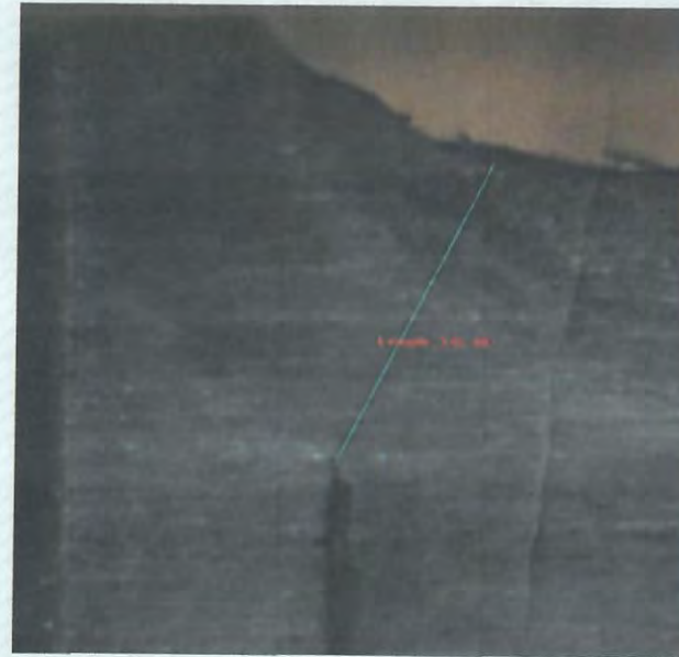
شکل 11 تصویر ماکروسکوپی از مقطع عرضی آماده سازی شده. (مقطع 11) محلول ظاهر کننده: نایتال ده درصد
