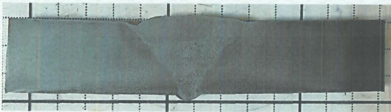
شکل ۱. تصویر ماکروسکوپی از مقطع عرضی آماده سازی شده. محلول ظاهر کننده؛ نایتال ده درصد
