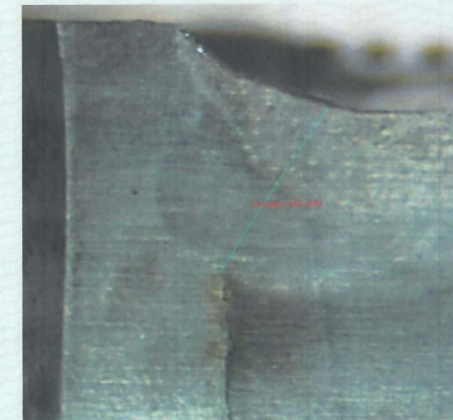
شکل 35. تصویر ماکروسکوپی از مقطع عرضی آماده سازی شده. (مقطع 35) محلول ظاهر کننده: نابتال ده درصد
