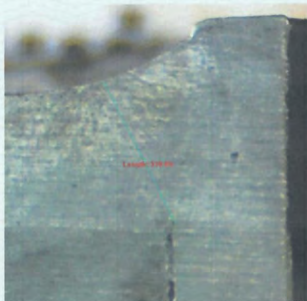
شکل 36. تصویر ماکروسکوپی از مقطع عرضی آماده سازی شده. (مقطع 36) محلول ظاهر کننده: نایتال ده درصد
