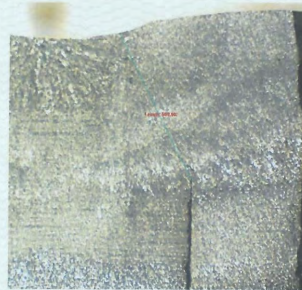
شکل 24. تصویر ماکروسکوپی از مقطع عرضی آماده سازی شده. (مقطع 24) محلول ظاهر کننده: نایتال ده درصد
