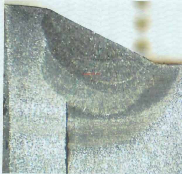
شکل 16. تصویر ماکروسکوپی از مقطع عرضی آماده سازی شده. (مقطع 16) محلول ظاهر کننده: نایتال ده درصد
