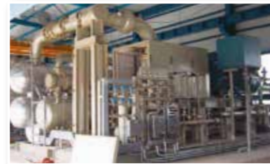
LNG BOG compressor - Turkey 400S / 830kW
